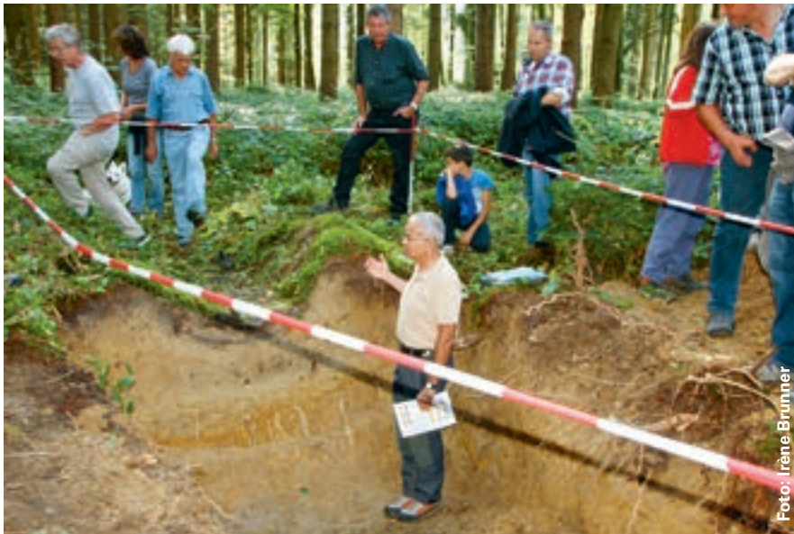
Bodenprofil, das in einer alten Rückegasse gegraben wurde. Die Fahrspuren respektive Spurrinnen mit dem seitlich aufgewölbten Boden sind an der Profilwand deutlich sichtbar.
